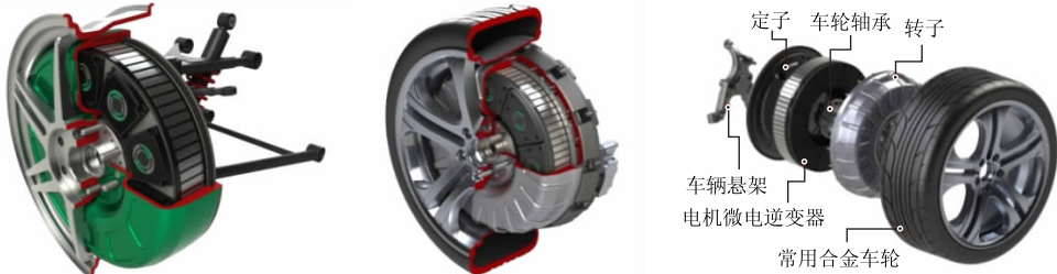
图1 Protean Electric 出品的轮毂电机系统
