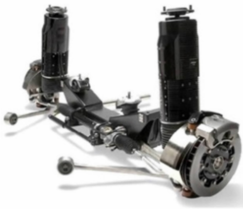
图 4 Bose 开发的直线电机电磁主动悬架系统
