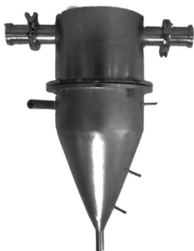
图 3 双室涡旋发生器实物图
