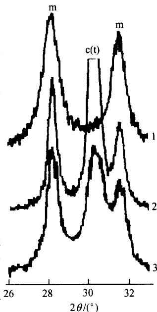
图3 以硫酸锆为原料分别在 3 种不同酸碱度条件下水热反应产物的 XRD 谱 1 示 pH = 4, 2 示 pH = 9, 3 示 pH = 14
