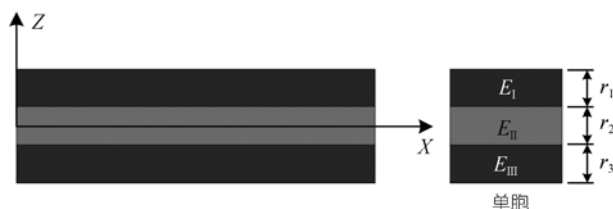
图 4 三层材料结构及其单胞
