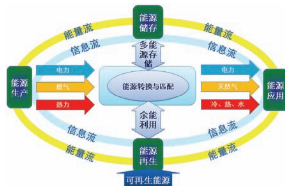
图3 分布式能源网络节点的四环节结构
