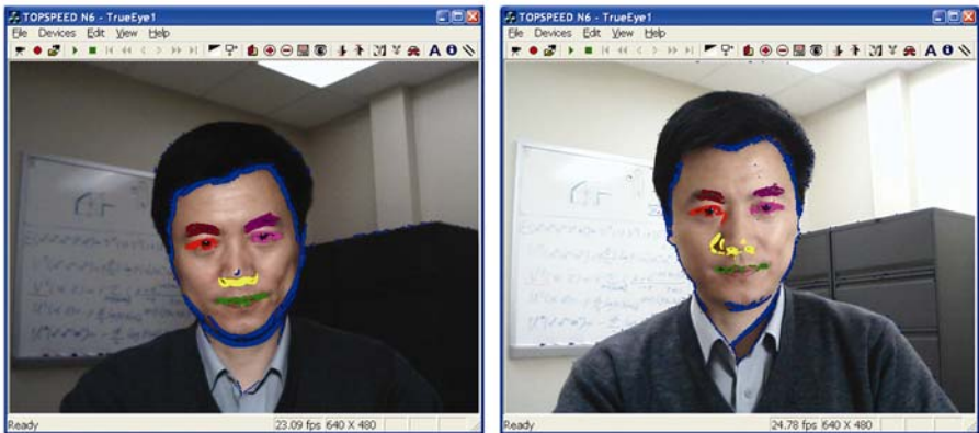
图 3 光照发生明显变化的情形下人脸特征实时提取效果, 光线变暗(左图), 侧光源(右图)
