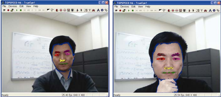
图 4 视频目标尺寸明显变化(左图)和受到手部干扰(右图)的情形下人脸特征实时提取效果
