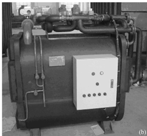
图9 双分离热管型回热回质吸附制冷机 (a) 发明专利系统图, (b) 实际产品
