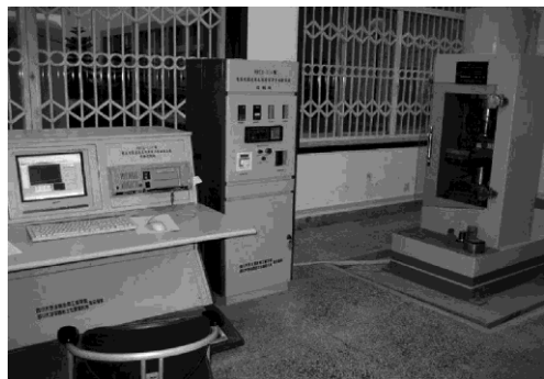
图 2 RMTS150 型程控伺服混凝土与岩石力学实验系统
