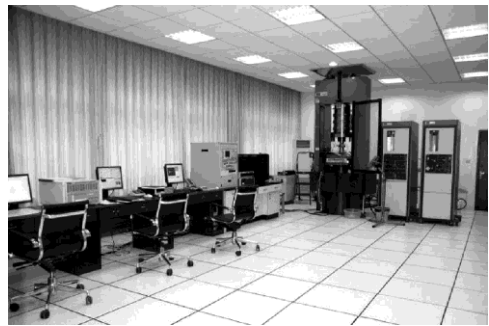
图 1 MTS815 Flex Test GT 岩石力学实验系统
