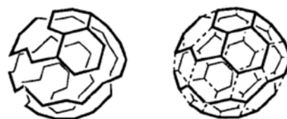
图 4 含螺旋型多炔碳链的富勒烯中间体缩合形成富勒烯 C_{60} 示意图 [25]
