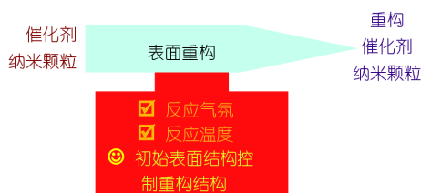
图 14 催化剂纳米颗粒初始表面结构控制重构结构概念示意图(网络版彩图)
