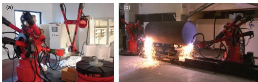
图3 (网络版彩色)TriVariant机器人工程应用(Atomrobot. http://www.cxrobot.com/gggh/0819_16.html ). (a) 消失模节点双机器人工作站; (b) 相贯线切割双机工作站
