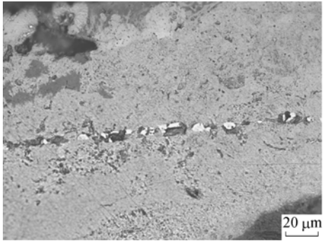
图 4 M27:391 铁刃中的夹杂物变形拉长
