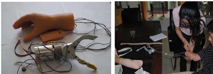
图 12 (网络版彩图) 力触觉反馈肌电控制假手
