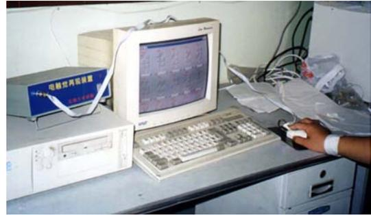
图 5 (网络版彩图) 基于电刺激的虚拟触觉再现装置
