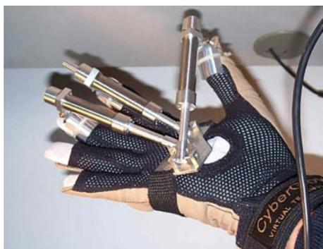
图 7 (网络版彩图) 力反馈数据手套
