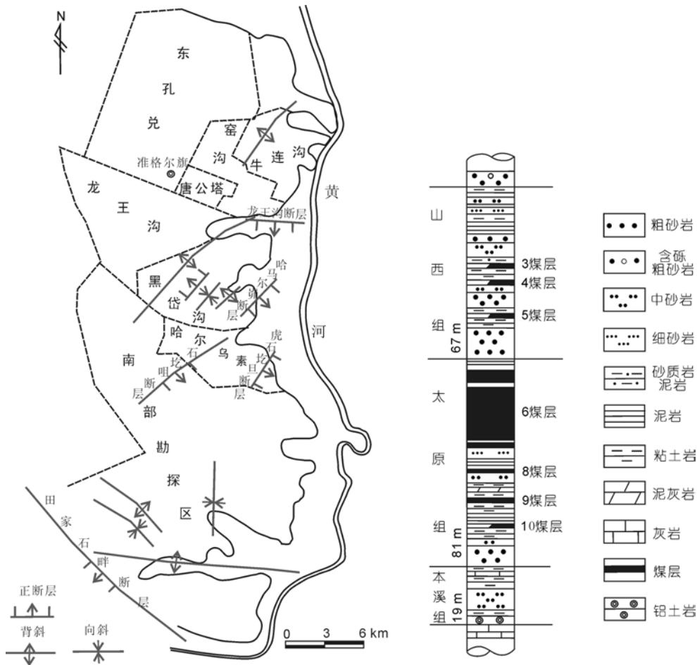
图 1 准格尔煤田构造纲要简图与含煤地层岩性柱状图
