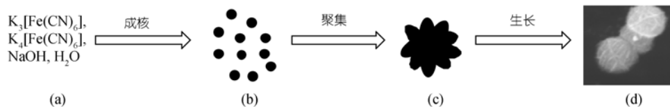
图 7 核桃形球状颗粒球形颗粒的生长机理示意图
