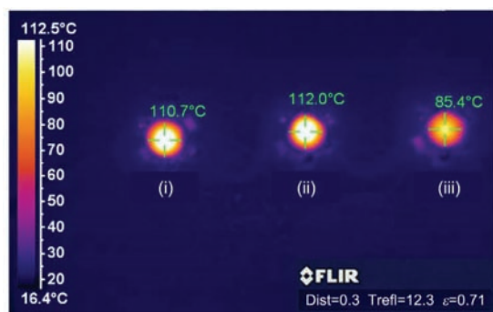
图12 (网络版彩色)3种类型QLED在300 mA驱动电流下的红外热像图
