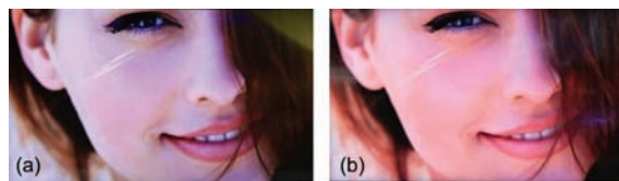
图3 (网络版彩色)液晶显示屏效果对比图. (a) 以传统荧光粉LED作背光; (b) 以QCLED作背光 [17]
