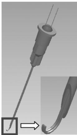
图 1 自制的刺激和记录电极
