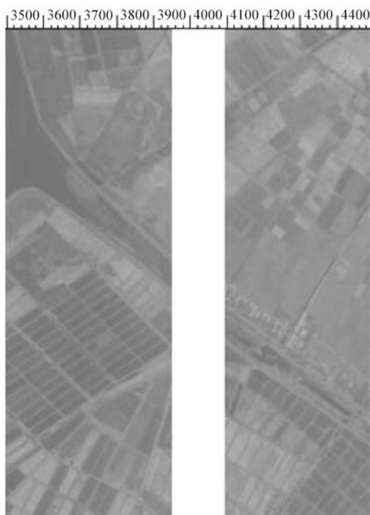
图 7 偏流角未补偿前中间与右边 CCD 拼接情况
