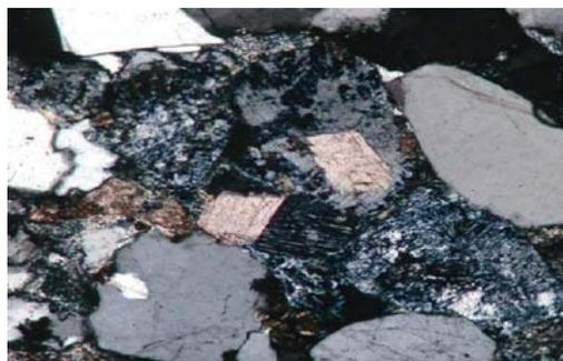
图 7 西 13-1 井(2450.87 m)铁白云石交代长石(正交×100)
