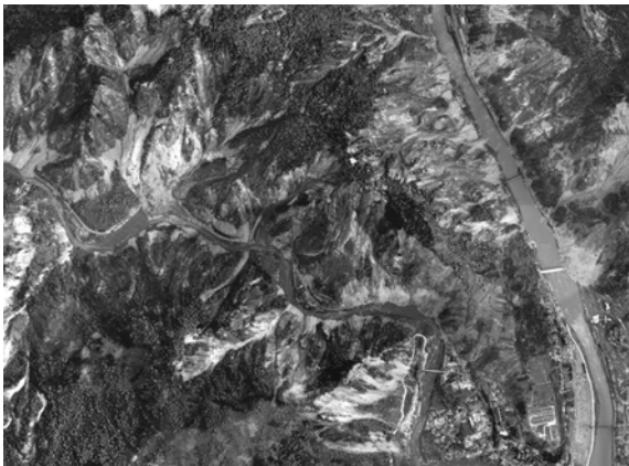
图 4 5.12 地震在映秀镇地区触发的坡面泥石流
