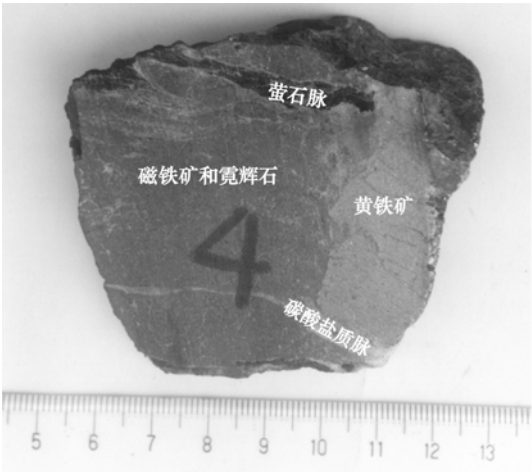
图 1 白云鄂博矿床黄铁矿与稀土矿化关系(手标本照片)
