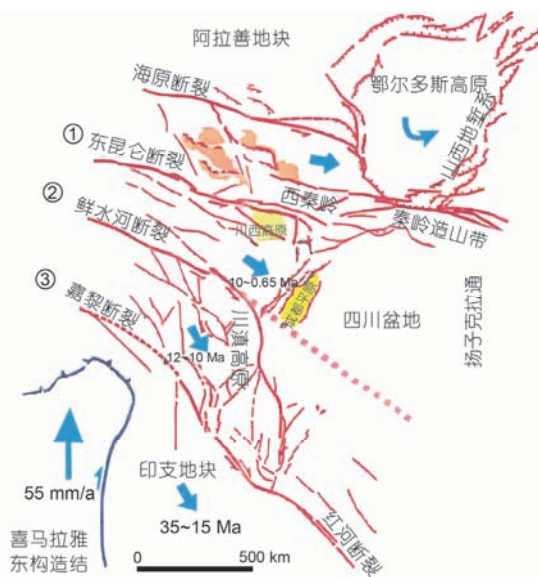
图 10 青藏高原东北地域深部物质流展轨迹分布示意图。①通道, 海原断裂与东昆仑断裂所辖物质流动通道; ②通道, 东昆仑断裂与鲜水河断裂所辖物质流动通道; ③通道, 鲜水河断裂与嘉黎断裂所辖物质流动通道
