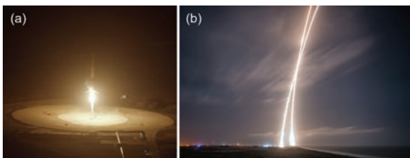
图3 Falcon 9火箭一子级成功完成陆地回收试验。(a) 箭体着陆;(b) 弹道轨迹
