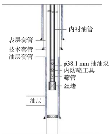
图2 预制内防喷工具不压井作业管柱
