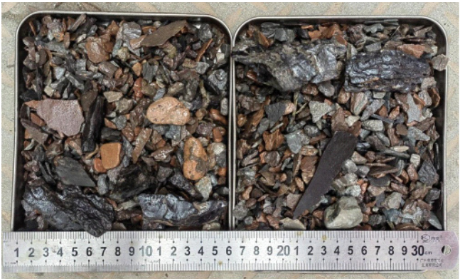
图 8 加入可降解纤维的重稠浆举砂携带出的井下掉块照片
