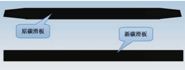
图 7 新碳滑板与原碳滑板对比示意图
