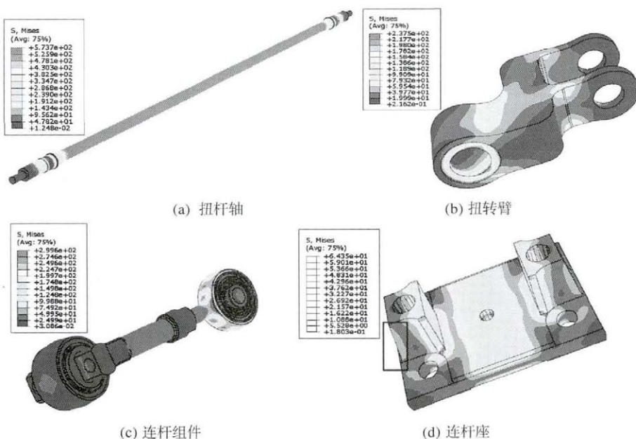
图5 在 30 \text{ kN} 极限载荷下各零部件应力云图
