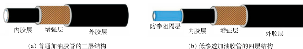
图 5 不同类型加油胶管的结构示意图
