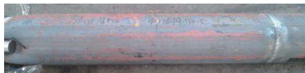
图7 膨胀波纹管试样膨胀后的外观
