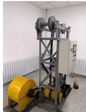
图 1 新型滚筒式抽油机试验设备
