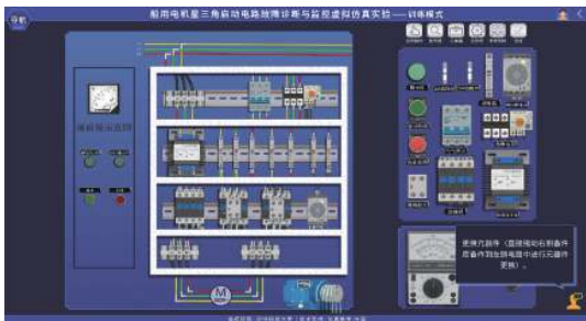
(a) 船用电机控制柜及控制电路虚拟仿真交互界面
