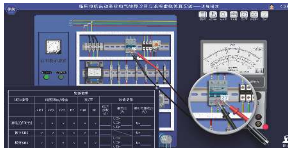
图5 万用表测量电路状态
