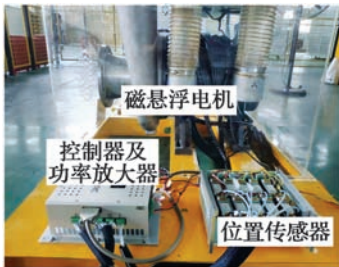
图 17 磁悬浮轴承系统实验平台 Fig. 17 Test platform for the active magnetic bearing
