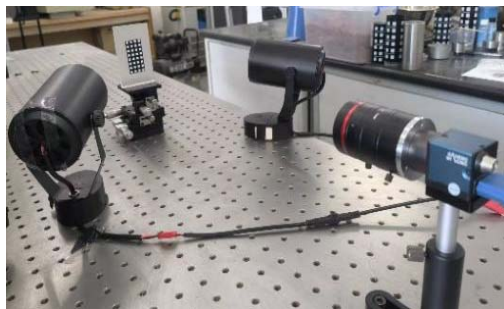
图6 刚体位移测量系统
