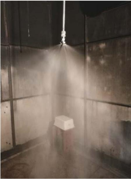
图5 旋流式雾化喷嘴液滴直径测量图
