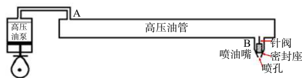
图4 高压油管实际工作过程示意图
