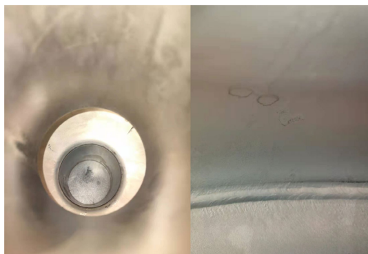
图 13 后续改进的 1.3 GHz 铌三锡腔表面形貌(在线彩图)
