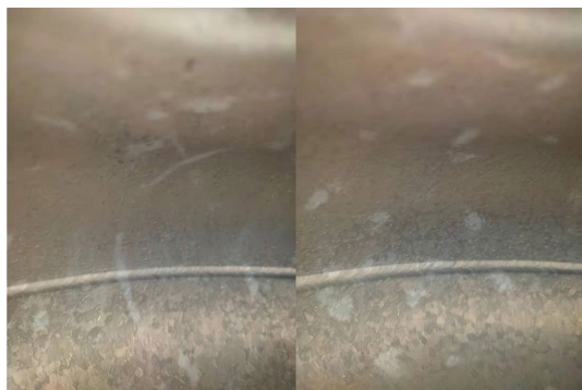
图 12 垂测后 1.3 GHz 铌三锡腔表面形貌(在线彩图)
