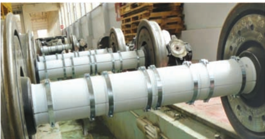
图 6 车轴采用非金属型机械式防护
