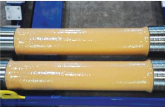
图 4 喷涂 REVOTECT 涂层后的车轴
