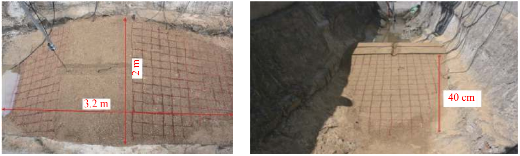
图 2 堰塞坝几何形态设计情况
