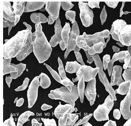
图 1 原料锌粉的扫描电镜图像
