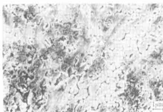
图3 薄膜脱离后衬底的SEM照片
