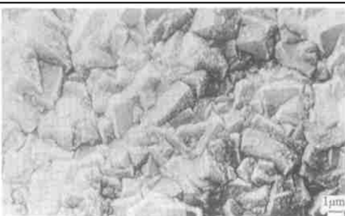
图2 金刚石薄膜正面的SEM照片
