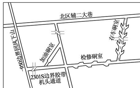
图 2 无轨胶轮车加油、检修、存放硐室布置
