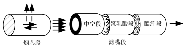
图 1 电加热烟草产品主要成分转移示意图
