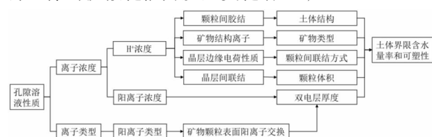
图 3 孔隙溶液与粘土矿物相互作用下的土体液化过程
