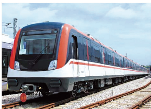
图 1 长沙地铁 1 号线永磁同步牵引系统列车
