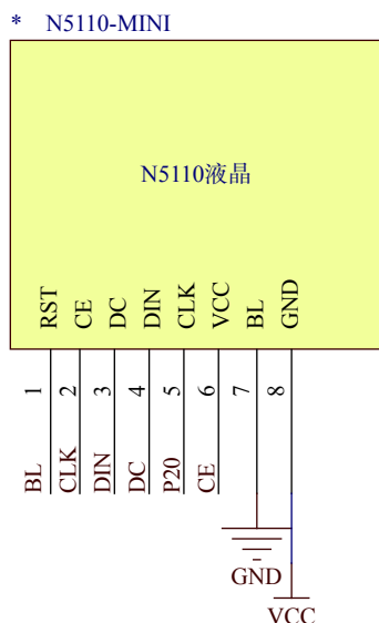
图8 N5110 与单片机之间的连接图
