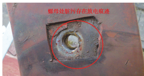
图 4 烧灼的螺母和热塑套碎屑
