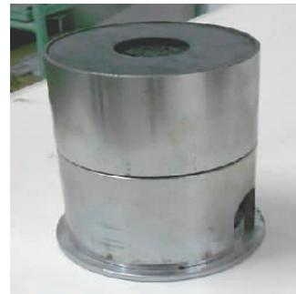
图2 滑移剪切试验仪
