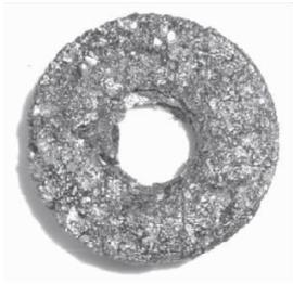
图 3 滑移剪切破坏后的试件
