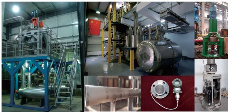
大型熔盐实验回路与关键设备样机
