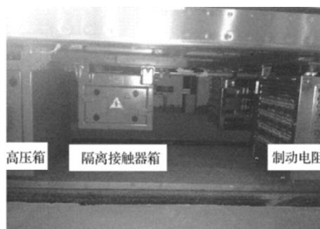
图4 接触器箱安装位置
