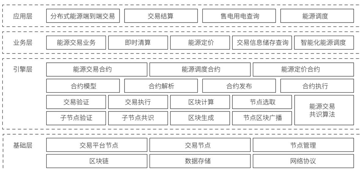
图2 系统架构图
